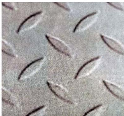
在击昏围栏、承重区域和限制围栏等区域使用新型的金属板材来替代传统图案式的金属可有效降低滑倒问题。新型的地面板材具有激光插入的金属凸起结构，能够提供更大的摩擦力。这种板材具有和图案式金属一样的耐用性，但其凸起结构带来了较高的磨蚀性。
