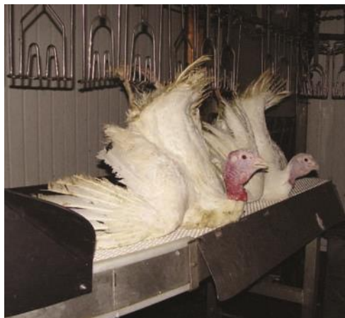
Figure 4. Poulets de chair et dindes sur un dispositif d'appui. Le dispositif avance au même rythme que la chaîne d'accrochage. Une fois chaque oiseau accroché et installé de façon adéquate sur le dispositif, l'opérateur plie ses ailes et les referme dans leur position naturelle, pour réduire le risque de chocs électriques préalables à l'étourdissement.
