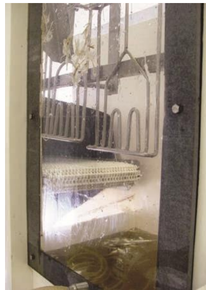
Figure 12. Bain d'eau électrique ouvert. Les dimensions spacieuses de ce bain d'eau empêchent les oiseaux de se frapper les ailes contre les parois latérales ou de se retrouver coincés contre elles. Le dispositif permet à l'opérateur de vérifier si l'étourdissement des oiseaux est immédiat et de s'assurer du niveau d'immersion de leur tête dans l'eau électrifiée sur toute la longueur du bain d'eau. Pour des raisons de santé et de sécurité, le bain d'eau ouvert peut-être entouré d'une cage en grillage métallique afin d'en bloquer l'accès au personnel non-autorisé et de réduire ainsi le risque d'électrocution accidentelle. Photo : Formation à destination des responsables du bien-être des volailles, Université de Bristol
