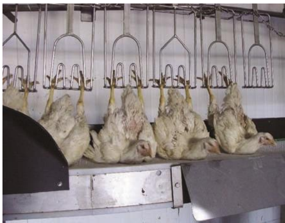
Figure 4. Poulets de chair et dindes sur un dispositif d'appui. Le dispositif avance au même rythme que la chaîne d'accrochage. Une fois chaque oiseau accroché et installé de façon adéquate sur le dispositif, l'opérateur plie ses ailes et les referme dans leur position naturelle, pour réduire le risque de chocs électriques préalables à l'étourdissement.
