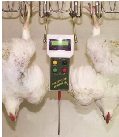
Figure 25. Dispositif de contrôle à distance de l'étourdissement. Ce matériel oppose le même niveau de résistance qu'un oiseau vivant et estime l'amplitude de courant pour chaque oiseau (Wotton & Wilkins, 2004). Photo : AGL Consultancy Ltd.
