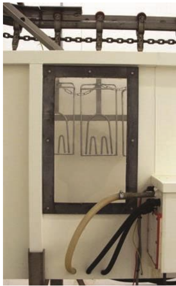
Figure 12. Bain d'eau électrique ouvert. Les dimensions spacieuses de ce bain d'eau empêchent les oiseaux de se frapper les ailes contre les parois latérales ou de se retrouver coincés contre elles. Le dispositif permet à l'opérateur de vérifier si l'étourdissement des oiseaux est immédiat et de s'assurer du niveau d'immersion de leur tête dans l'eau électrifiée sur toute la longueur du bain d'eau. Pour des raisons de santé et de sécurité, le bain d'eau ouvert peut-être entouré d'une cage en grillage métallique afin d'en bloquer l'accès au personnel non-autorisé et de réduire ainsi le risque d'électrocution accidentelle. Photo : Formation à destination des responsables du bien-être des volailles, Université de Bristol
