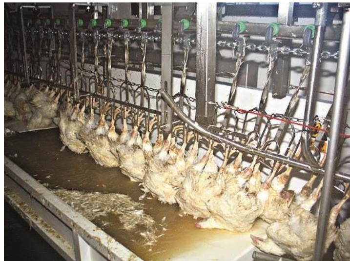
Figure 12. Bain d'eau électrique ouvert. Les dimensions spacieuses de ce bain d'eau empêchent les oiseaux de se frapper les ailes contre les parois latérales ou de se retrouver coincés contre elles. Le dispositif permet à l'opérateur de vérifier si l'étourdissement des oiseaux est immédiat et de s'assurer du niveau d'immersion de leur tête dans l'eau électrifiée sur toute la longueur du bain d'eau. Pour des raisons de santé et de sécurité, le bain d'eau ouvert peut-être entouré d'une cage en grillage métallique afin d'en bloquer l'accès au personnel non-autorisé et de réduire ainsi le risque d'électrocution accidentelle. Photo : Formation à destination des responsables du bien-être des volailles, Université de Bristol
