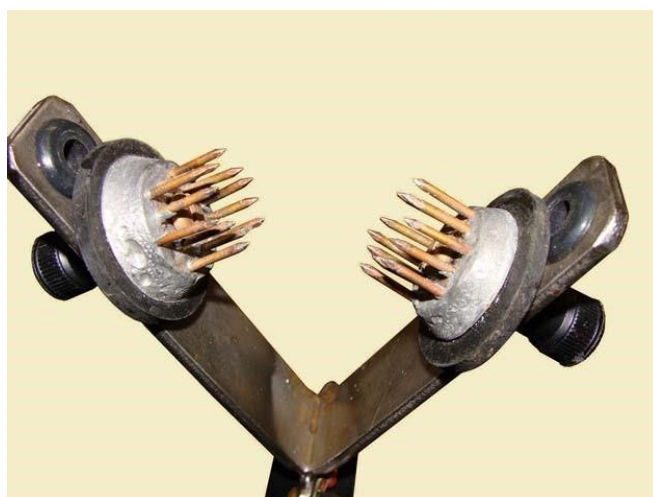
Контактные электроды ручного электрического оглушителя.
